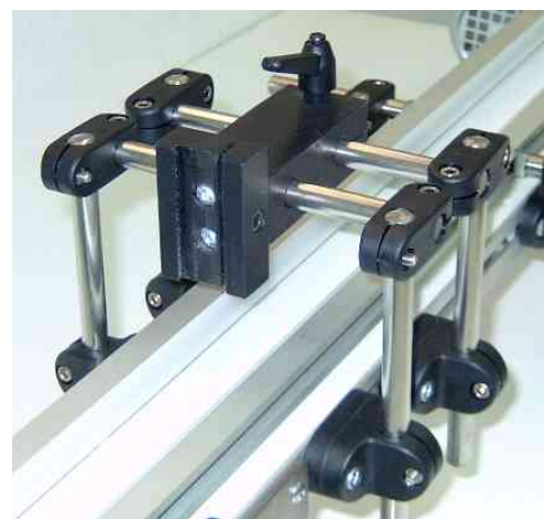
Detalle soporte cabezal para impresora Domino Serie A
