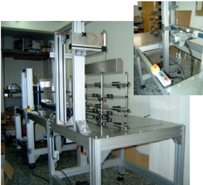
Máquina automática para realizar la impresión de cajas sin formar. Posibilidad de impresión en ambas caras.
